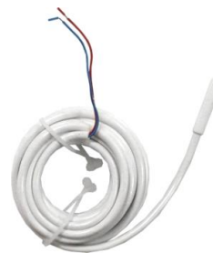
Välisandur NTC tüüpi 10k \Omega Temperatuuril 25°C ( \beta = 3950 )
