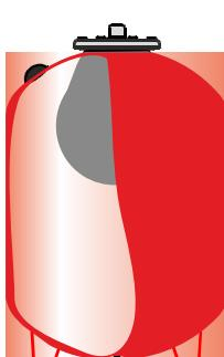
Gradualmente la temperatura dell'impianto inizia a scendere e con essa il volume dell'acqua, il vaso cede ora l'acqua all'impianto grazie alla pressione dell'aria della camera pressurizzata sino al raggiungimento del volume iniziale ed il ciclo si riavvia.
