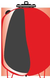
Il volume dell'acqua continua ad aumentare sino a quando, raggiunta la temperatura massima, la membrana occupa la quasi totalità del volume del vaso. La presenza della membrana evita qualsiasi contatto tra l'acqua e la superficie interna del vaso.
